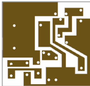
Sl. 13.9*. Drugačiji oblik (u odnosu na sl. 13.8 f ) štampanih veza ispravljača sa sl. 13.6.
